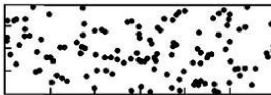
Рисунок А.8 — 8 % поверхности, 122 поры, d = 1 мм
